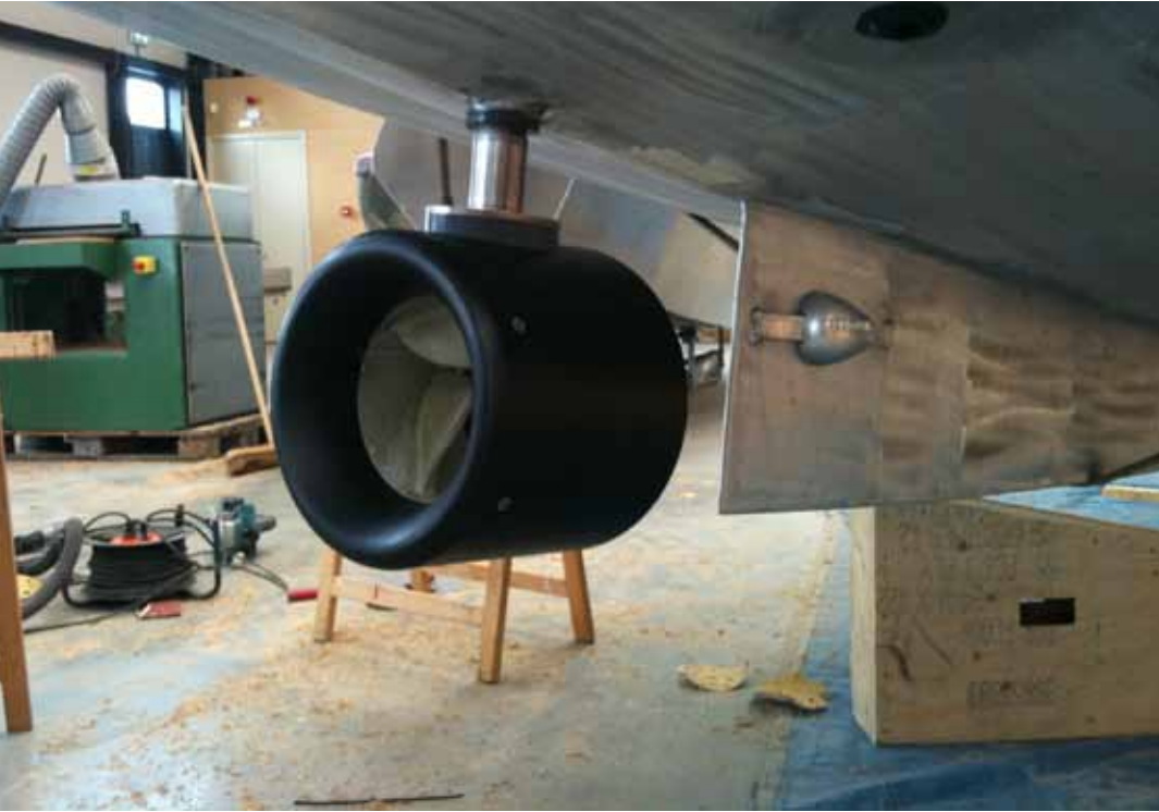
E-Motor (Größe 170), angebracht als POD Antrieb an einer holländischen Sloep
