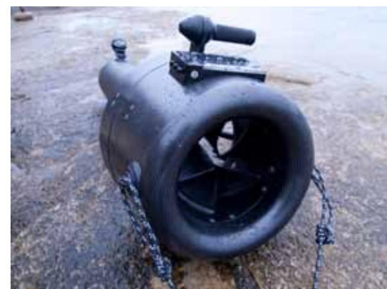
E-Motor, eingebaut in den Unterwasserscooter “Futurum”
